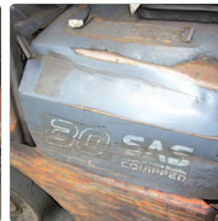
▶ Nadmierna korozja i odkształcenia.
