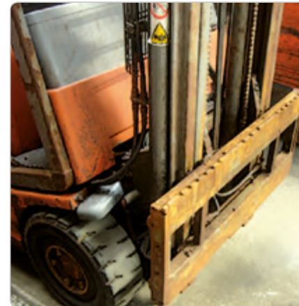
▶ Nadmierna korozja i brak obsługi.
