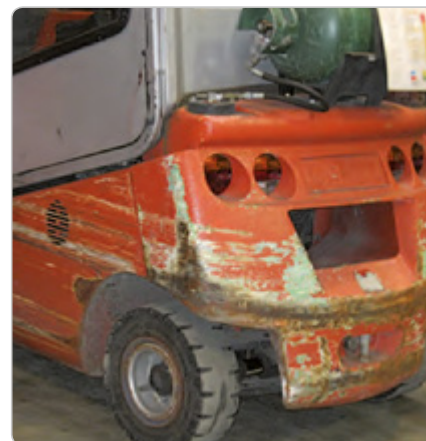
▶ Głębokie zarysowania i ubytki materiału.
