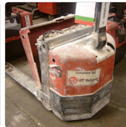
▶ Wózek ekstremalnie zanieczyszczony. ▶ Brak mocowania pokrywy.
